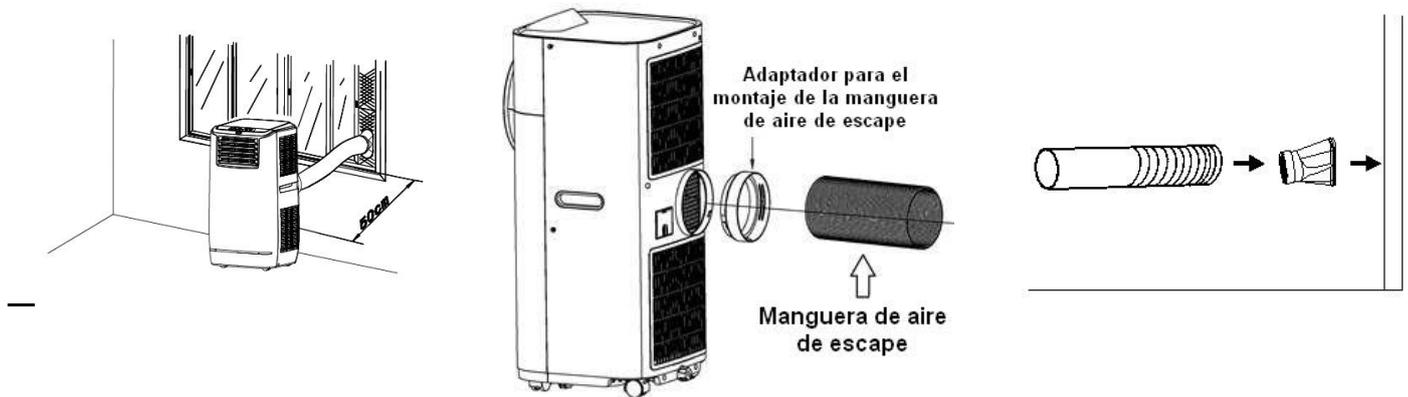
El acondicionador de aire móvil genera aire de escape caliente durante la refrigeración. Este aire caliente de salida debe ser expulsado al exterior. Puede dirigir el aire caliente de salida al exterior a través de un orificio adecuado (de 160 mm de diámetro) en la pared (similar a una campana extractora de cocina) o descargarlo a través de un hueco de una ventana/puerta abierta.
